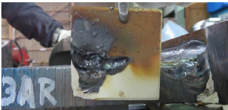
写真 11 3AR(エンド側)溶接後外観
