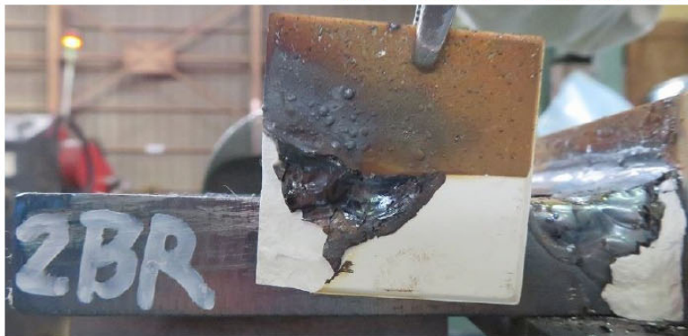
写真 9 2BR(エンド側)溶接後外観
