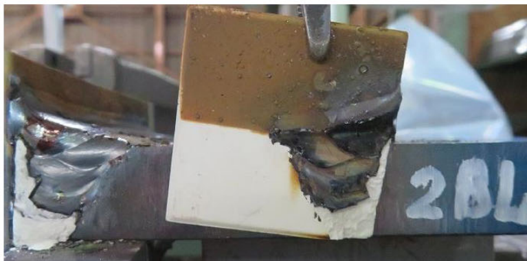
写真 8 2BL(スタート側)溶接後外観
