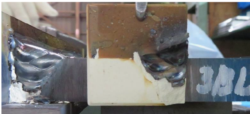
写真 12 3BL(スタート側)溶接後外観
