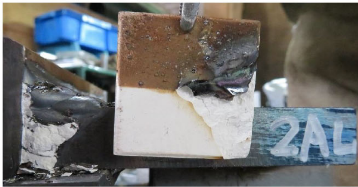
写真 6 2AL(スタート側)溶接後外観
