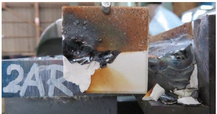
写真 7 2AR(エンド側)溶接後外観
