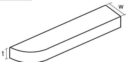
平鋼を寸法切断し、片端をR加工する。
