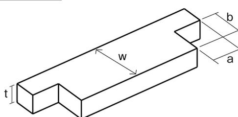
平鋼を寸法切断し、両端を直角に切削加工する。
