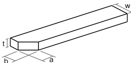
平鋼を寸法切断し、片端を斜めに加工する。
