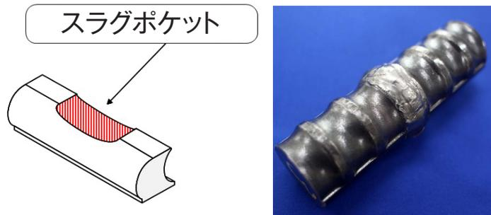
セラミックピースにスラグポケットを設けたことにより、溶接面を滑らかに仕上げることができます。
