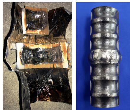
溶接性及び溶接後の剥離性がよく施工後の処理が楽に行えます。
