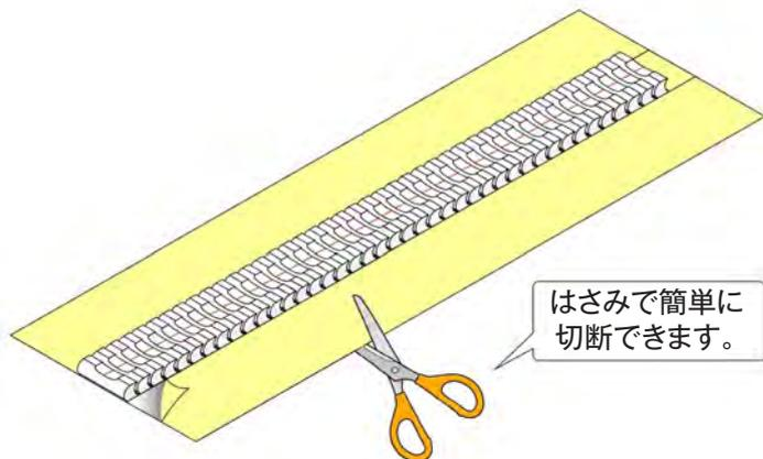
任意の長さで簡単に切断可能なので多様な鉄筋径に対応できます。
